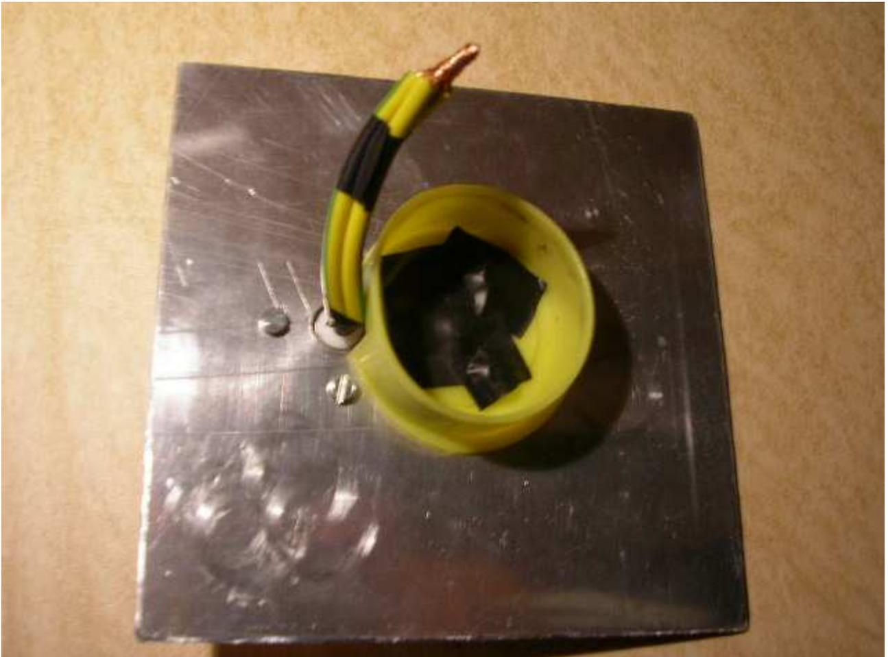
Saldiamo il i tre cavetti con il solenoide e poi isoliamolo con il nastro.
