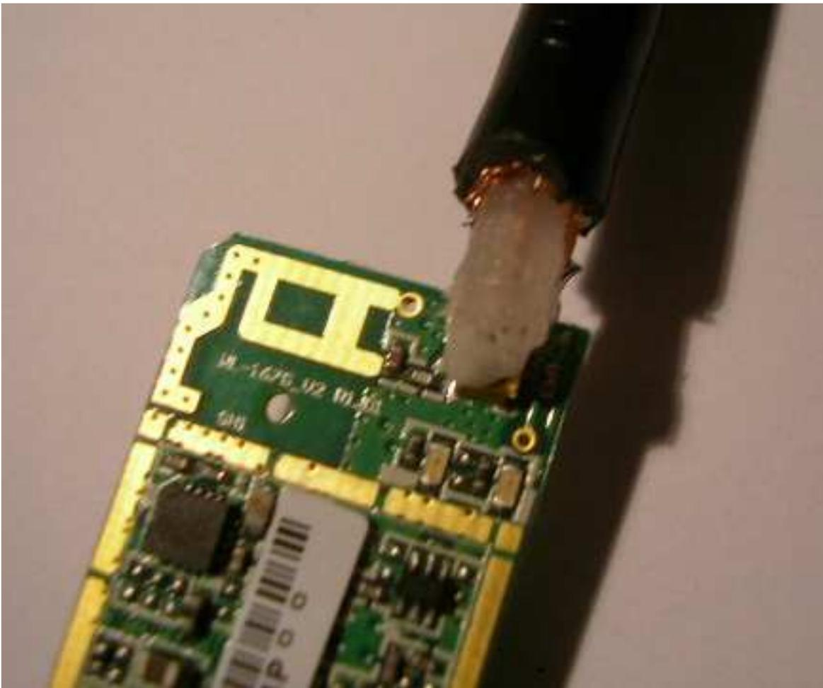
Il cavo coassiale è sistemato e quindi prendiamo il nastro isolante da elettricista e ricopriamo la parte in cui abbiamo effettuato la modifica. Non esagerate a ricoprire il circuito stampato con il nastro (come avevo fatto io all'inizio) perché dobbiamo fare attenzione a non coprire i diodi led in SMD. Non coprite il circuito stampato con il nastro oltre la linea rossa.
